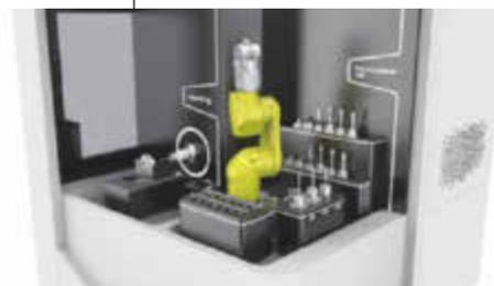
eine Werkstückpalette mit neuem Material, wird die Maschine selbstständig darauf eingerichtet, samt Vorrichtung, Werkzeugen und Messmittel. Auf Wunsch sind auch Nebenstationen für Vorprüfen, Nachmessen, Bürsten oder ölfreie Teile möglich. Der Roboter übernimmt dabei jeweils das Teilehandling. ●
