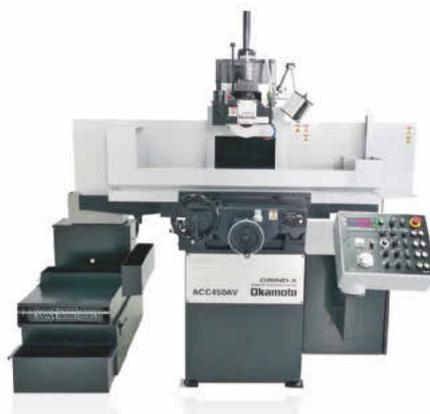
schubgröße 0,0001 mm, über elektronisches Handrad oder Tippzustellung. Darüber hinaus sind die Hydraulik- und Haupteinheit separat angebracht, um dem Einfluss von Wärmeausdehnung und Vibrationen auf das Werkstück vorzubeugen. Der Hersteller betont, dass Dank spezieller konstruktiver Details Oberflächengüten bis in den Nanometerbereich hinein wirtschaftlich herstellbar sind. ●
