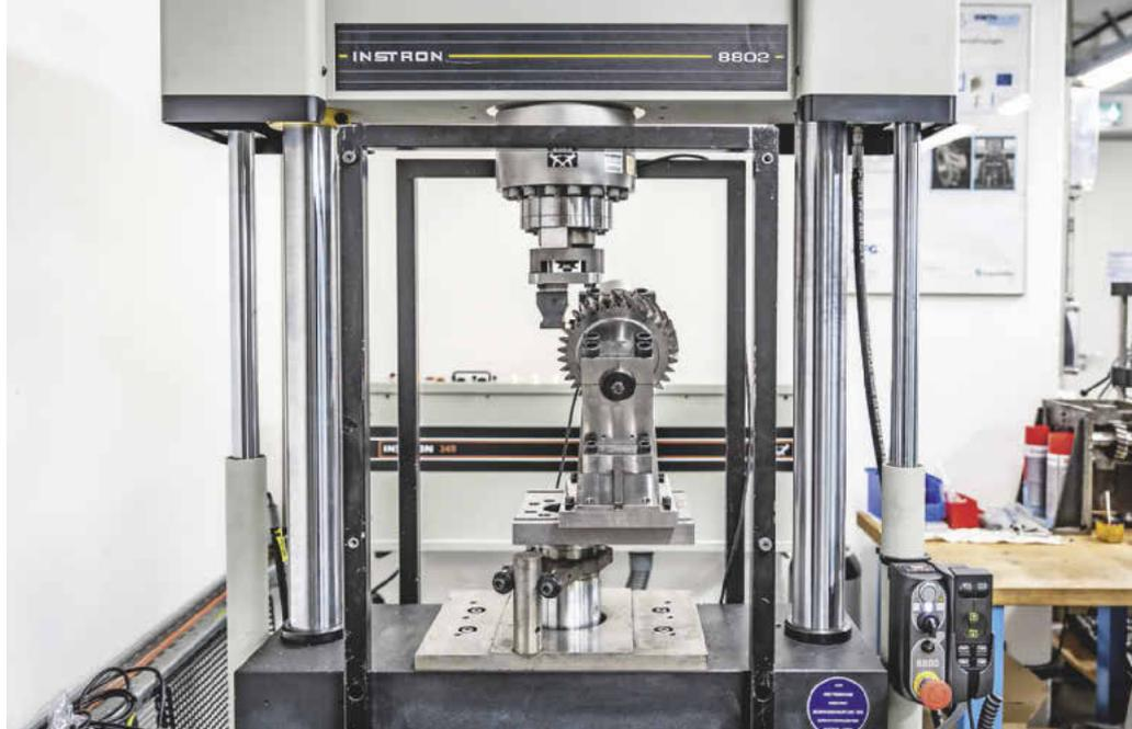
Prozess- und Bauteildaten von Zahnrädern werden detailliert geprüft. Um Simulationsmodelle zu validieren, vergleichen die Wissenschaftler deren Ergebnisse mit den realen Messwerten.
