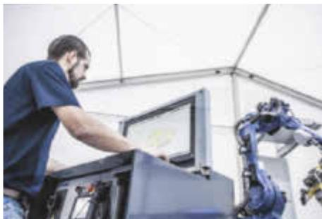
*Für die Programmierung des Bohrroboters wird ein BIM-Modell des Werkstatt- raums eingelesen. Bild: Yaskawa*
