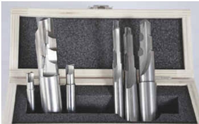
Die Experten von Iscar haben die Fräser und Bohrer als PKD-Sonderwerkzeuge fürs effiziente und wirtschaftliche Bearbeiten eines Bauteils aus dem Faserverbundwerkstoff GFK entwickelt.
