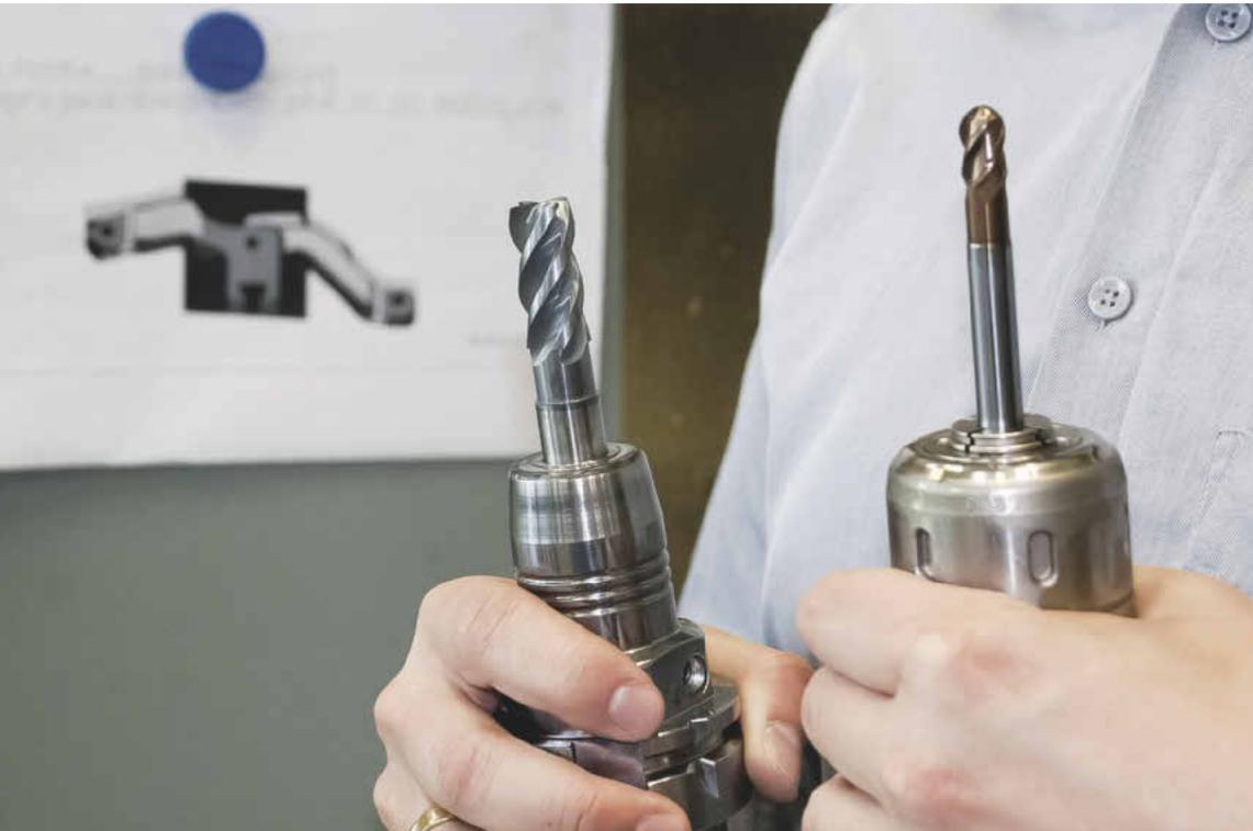
Mit dem Vollbartmetallfräser des Typs EPSM (links) wurde der Schieber erstmals trochoidal geschruppt und mit dem EHHB-Kugelfräser (rechts) vorgeschlichtet. Bilder: MMC Hitachi
