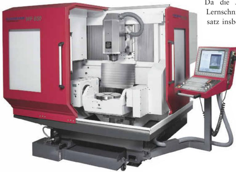
*Die automatische Vorschubreduzierung durch die AFR-Funktion ist künftig in allen CNC-Fräsmaschinen des Herstellers mit Heidenhain-Steuerung verfügbar.*
