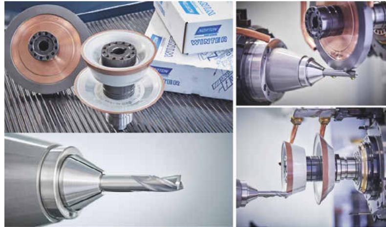
Die Q-Flute-Serie bietet mit den V-Prime-Diamant-Schleifscheiben zum Ausspitzen und Freiwinkelschleifen eine abgestimmte Lösung zur Schaftwerkzeugfertigung. Bild: Norton
