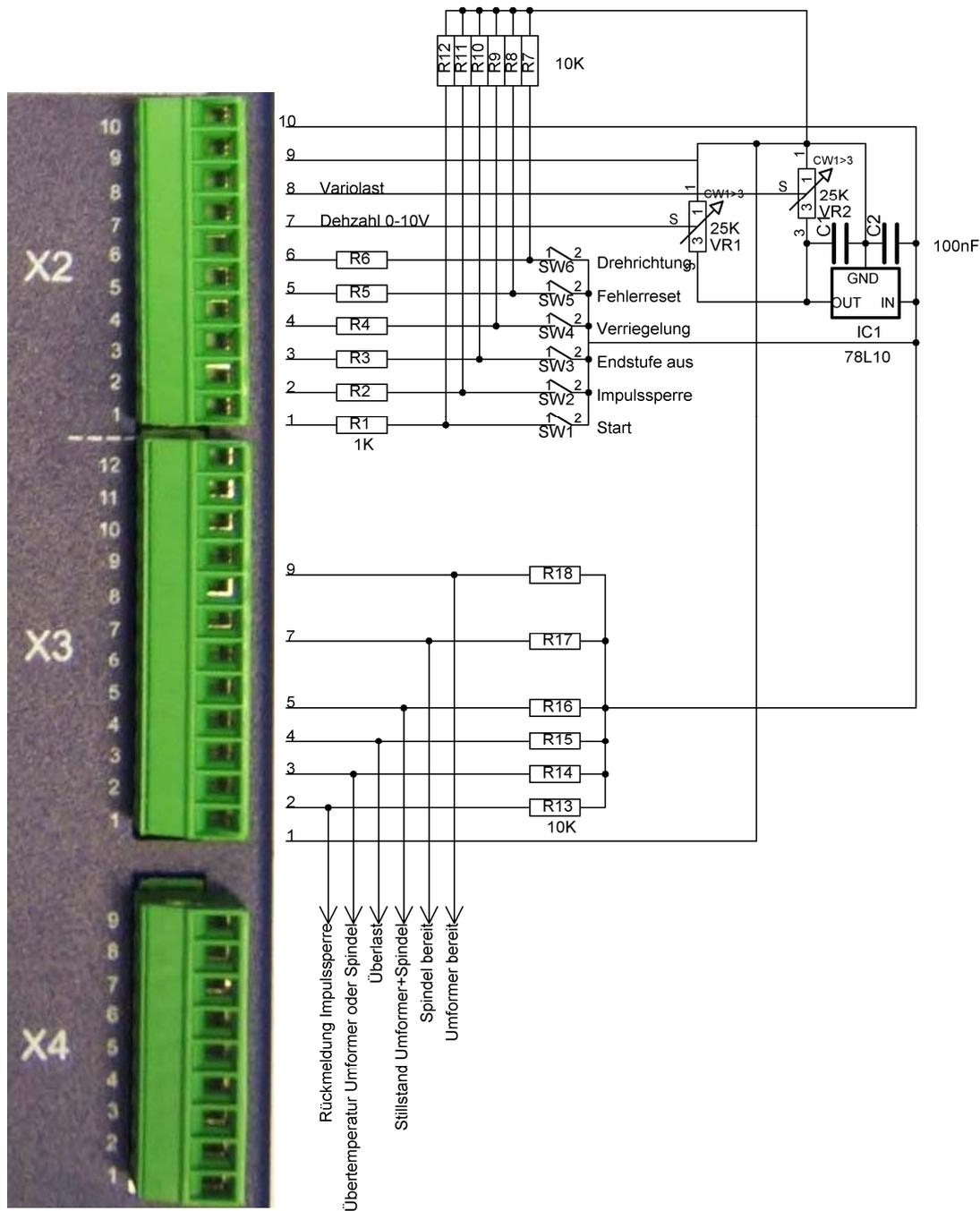
Das Spindelinterface X4 ist hier nicht verdrahtet, da die Verwendung sehr stark von der Konfiguration der Spindel und verschiedenen Kennlinien abhängt.
