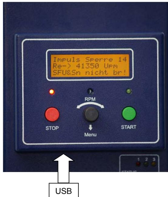
Als Option ist auch eine zusätzliche RS232 auf einer DSUB 9 verfügbar. Diese ist mit dem USB verknüpft und kann nur alternativ verwendet werden.
