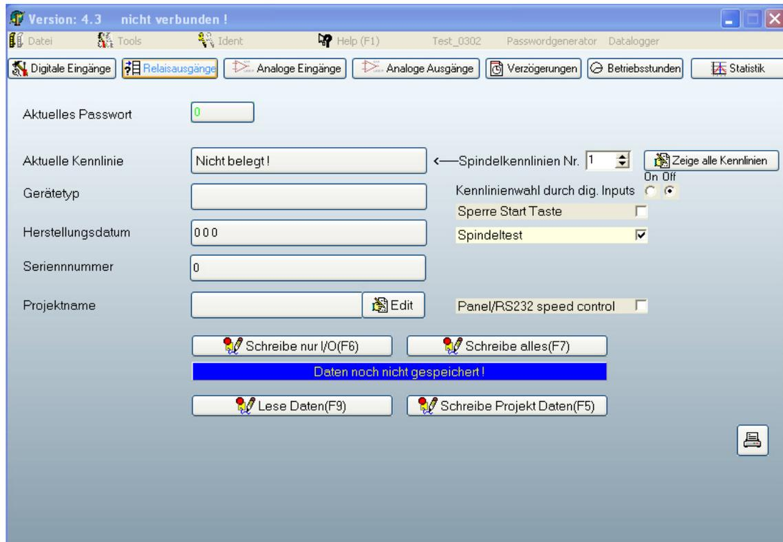
Es müssen lediglich die Kenndaten des Motors eingegeben werden. Wichtig ist, dass die Nennspannung richtig zur Drehzahl angegeben wird. Grund ist, dass Motoren auch in der Feldschwächung betrieben werden können, also eine höhere Drehzahl als die eigentliche Nenn Drehzahl erreichen können.
