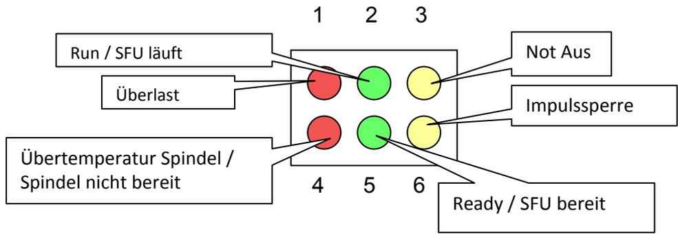
Typische LED Anzeigen. Andere Kombinationen sind möglich und müssen separat aufgeschlüsselt werden:
