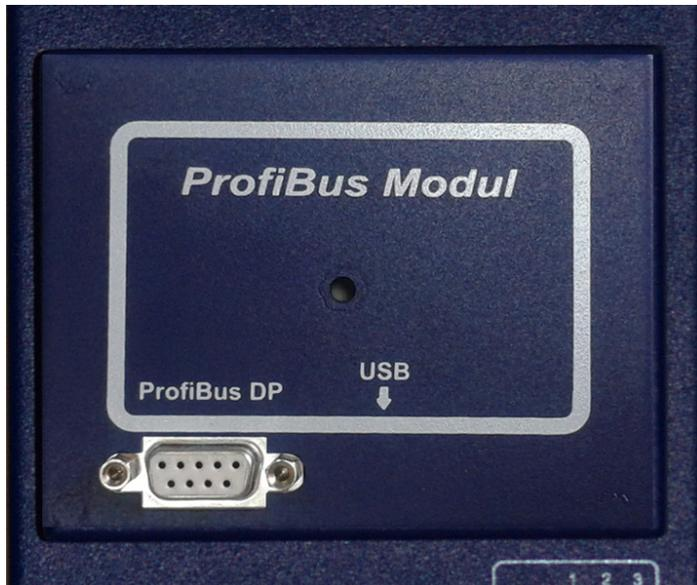
Die Einstellung der Profibusadresse erfolgt mittels RS232 Verbindungskabel und SFU Terminal Programm.
