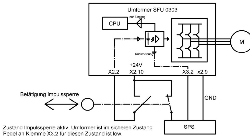
Nur für Testzwecke kann eine Brücke zwischen Klemme X2.2 und X2.10 gelegt werden. Damit läuft der Umformer, er darf jedoch nicht in Anlagen verwendet werden, welche nach EN 954-1 zertifiziert werden müssen !
