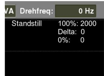
Wie im Beispielbild rechts zu sehen ist, wurde das System noch nicht genullt. Dabei ist deutlich zu erkennen, dass der 100% Wert hier 2000 größer ist, als der Nullwert. Diese Differenz lässt sich dann im Einstellungs Menü festlegen. Wenn der Motor nicht mehr angetrieben wird, erscheint wie im Beispielbild auch 0 für den Delta-Wert.
