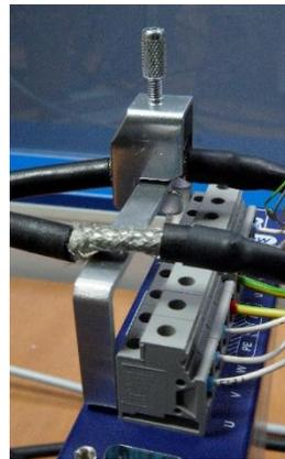
**Schraubklemmen:** Anschluss der Motorleitungen
